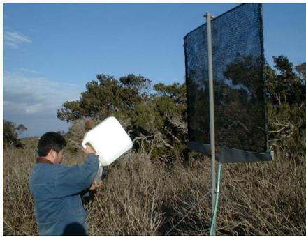
**Fig. 3.** Neblinómetro y el proceso de medición de agua captada.
